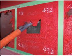
手工具(刃付スクレーパー、皮スキなど)で、塗膜はく離作業をおこないます。異なる塗付量で試験をおこなった場合、塗膜はく離結果のほか、塗付量ごとの作業状況を記録します。
