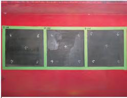
塗膜はく離後に残存した塗膜の種類、残存膜厚、再度の塗付作業の必要有無を確認、記録します。
